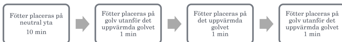
Figur 3-5 Testprocess för utvärdering av börvärde på komfortgolvvärme
